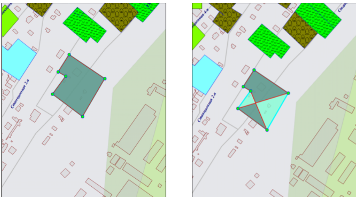
Рис. 2.152: Вид полигонального объекта до и после редактирования координат узлов в таблице
